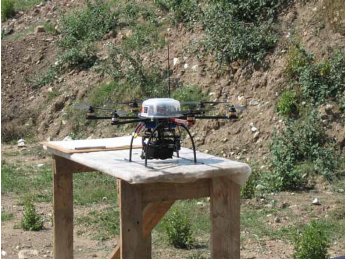
FIG. 9: Drone teleguidato con sistema di ripresa fotografica aerea
