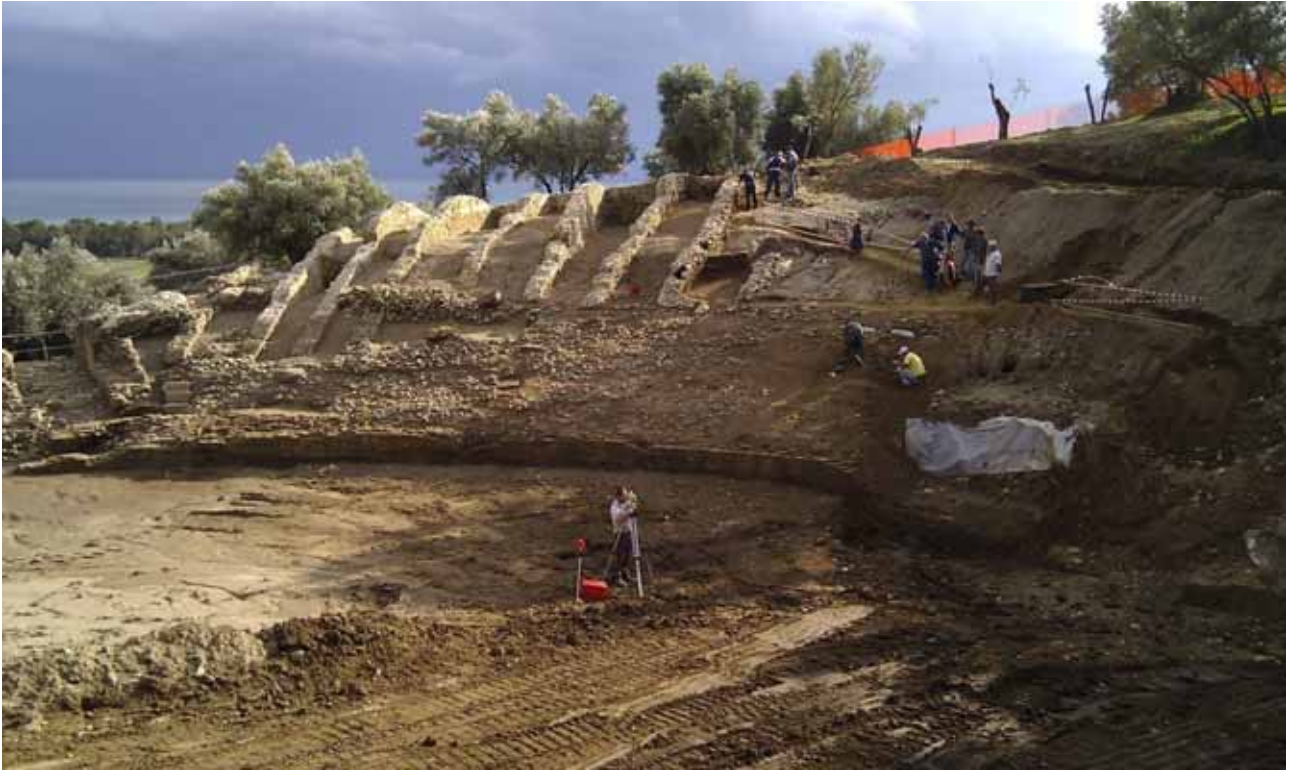
Figura 1. Misure mediante stazione totale in modalità "stazione libera".
