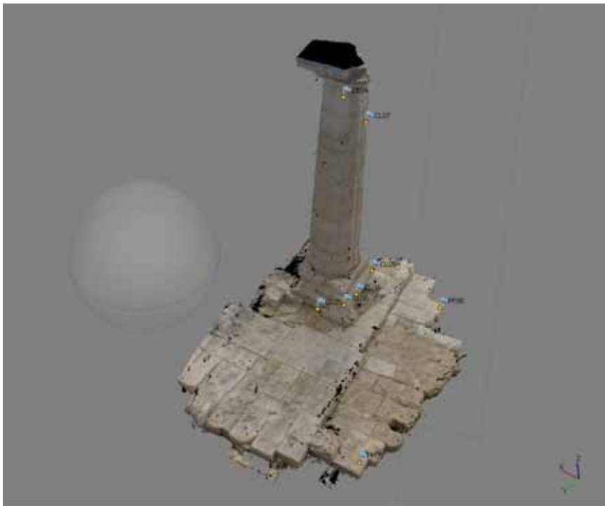
FIG. 23: Modello TIN realizzato con fotogrammetria a prese convergenti. Vista del modello 3D e dei punti di controllo con texture (modello ancora non ripulito)
