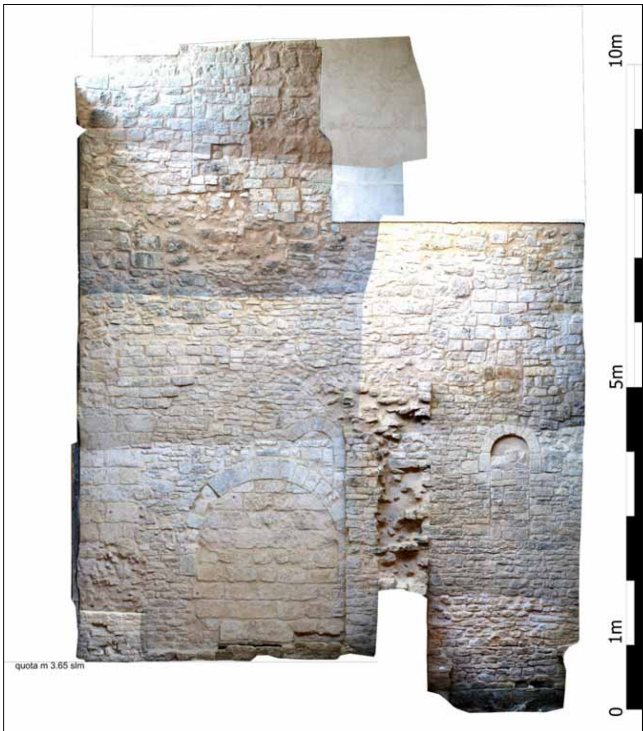
FIG. 8: Rilievo Fotogrammetrico. Ortofoto generata dalla elaborazione di sei coppie stereoscopiche riprese mediante asta attrezzata e creazione di modello TIN vestito di texture fotografiche Bari Santa Scolastica 2013 - area del bastione- Prospetto
