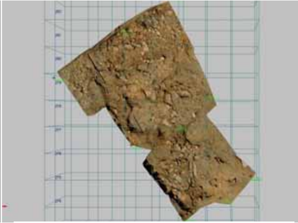
FIG. 5: Modello TIN generato dalla elaborazione di tre coppie stereoscopiche riprese mediante asta attrezzata e vestito di texture fotografiche– Visione zenitale
