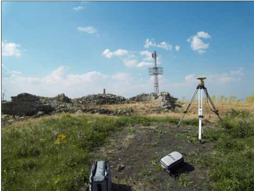
Figura 2. Misura mediante GPS topografico in modalità differenziale di uno dei capisaldi di un sistema locale a punti fissi.
