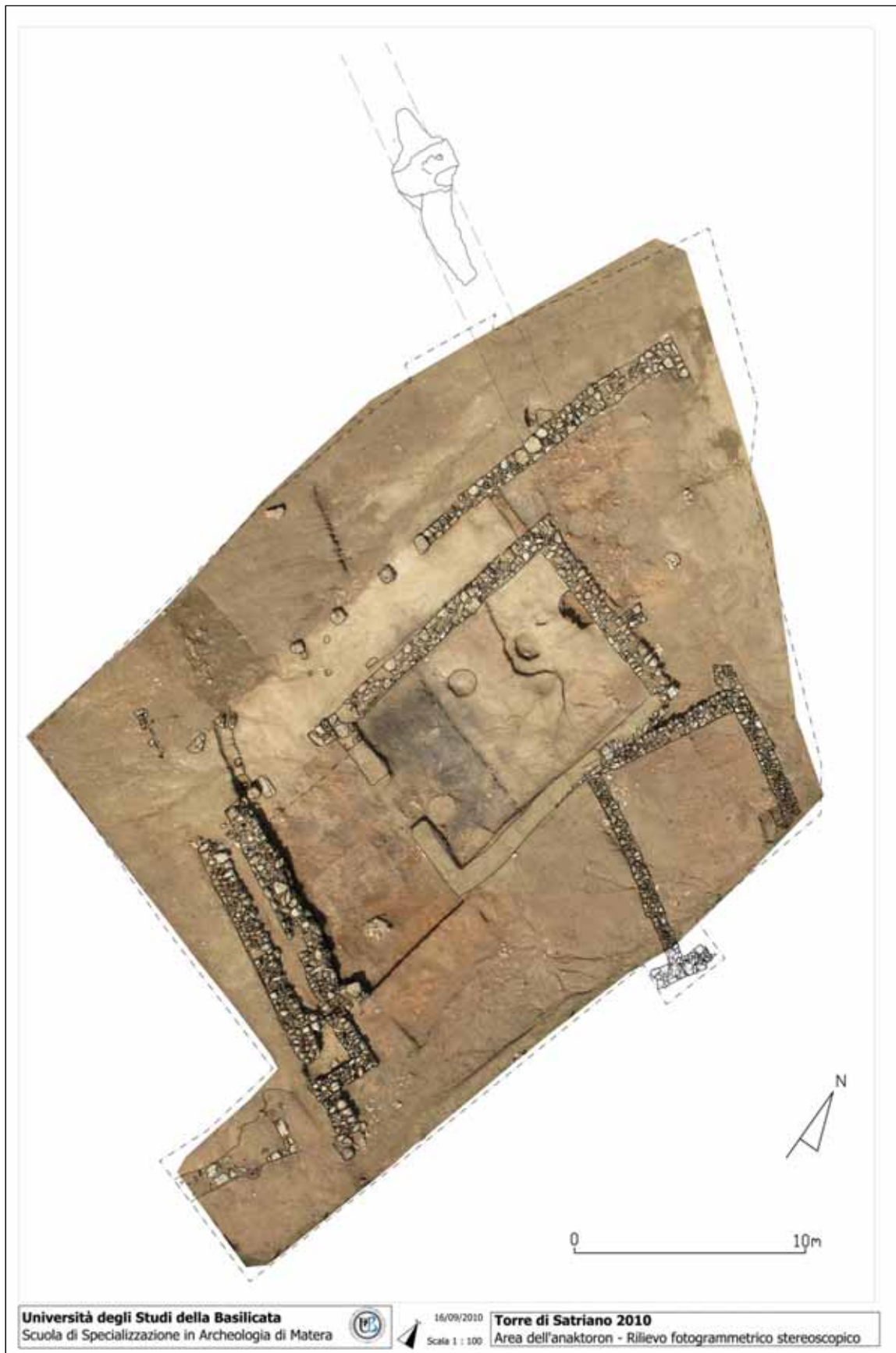
FIG. 16: Ortofoto generata dal modello TIN ad alta precisione di un'area di scavo archeologico realizzata mediante elaborazione della coppia stereoscopica, inserita in ambiente CAD e sovrapposta al rilievo archeologico realizzato mediante stazione totale e CAD
