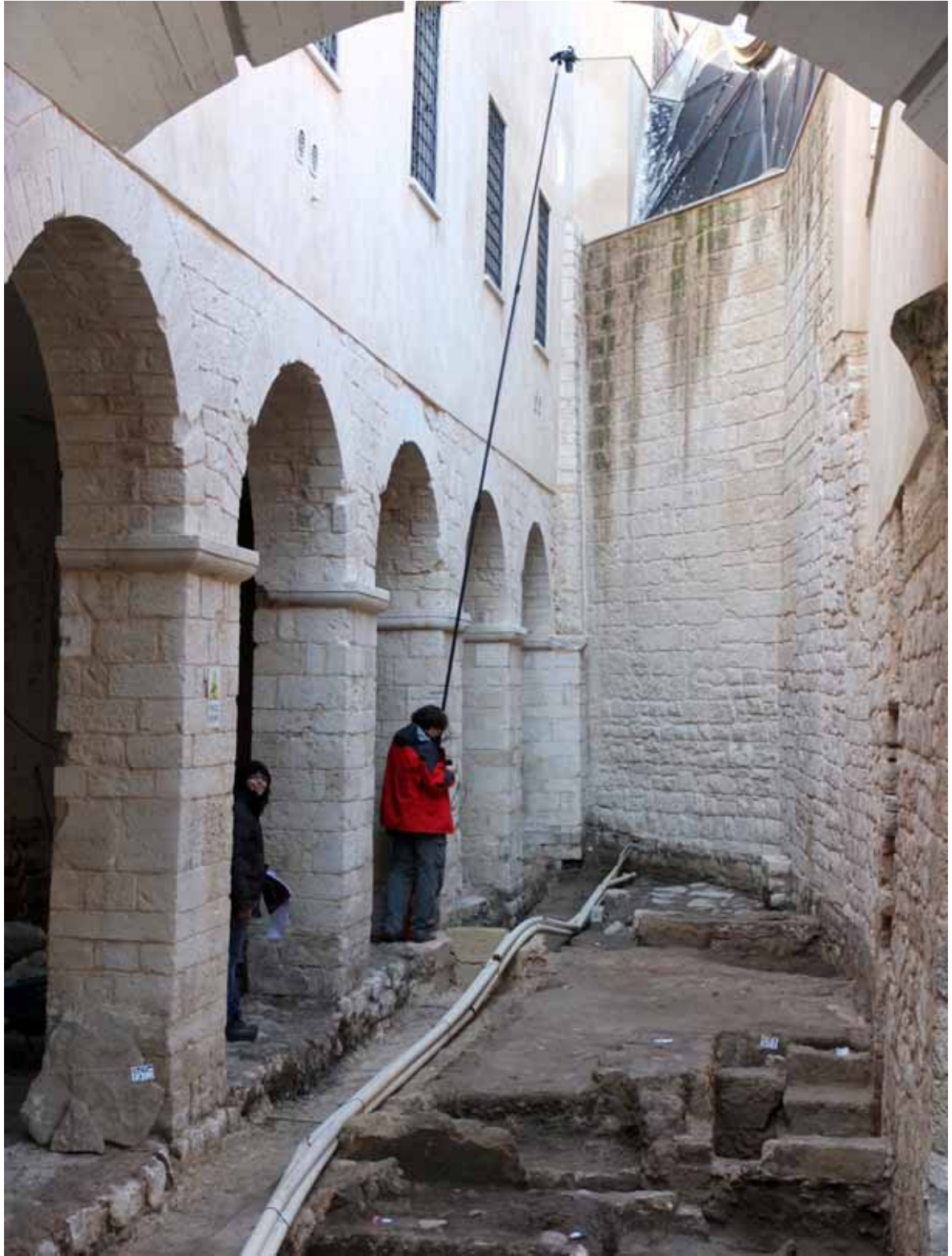
FIG. 3: Rilievo archeologico mediante asta fotogrammetrica attrezzata
